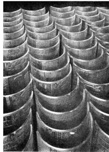
Clichés semi cylindriques obtenus par la stéréotypie à partir d'une forme plate typographique et destinés à l'impression sur machines rotatives.
