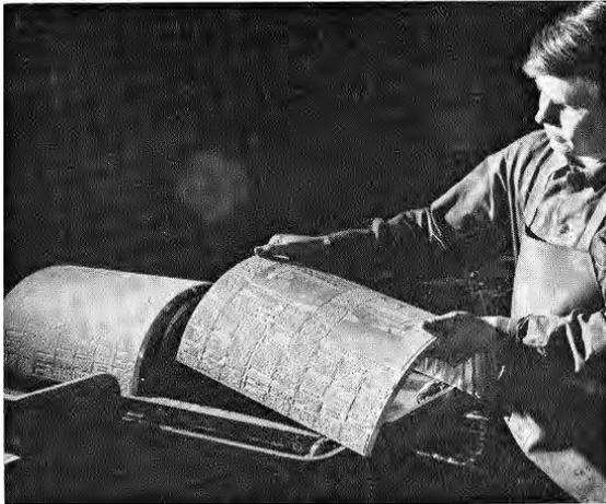
Stéréotypes demi-cylindriques sortant de la machine de finition.
